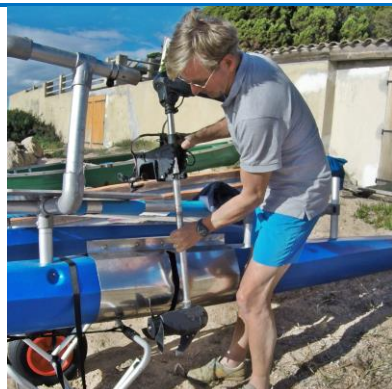
Mise en place du moteur
